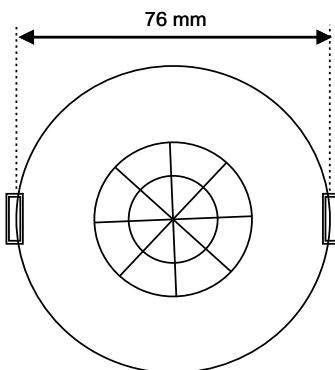
**ES** Este dispositivo está diseñado para montarse en el techo.
